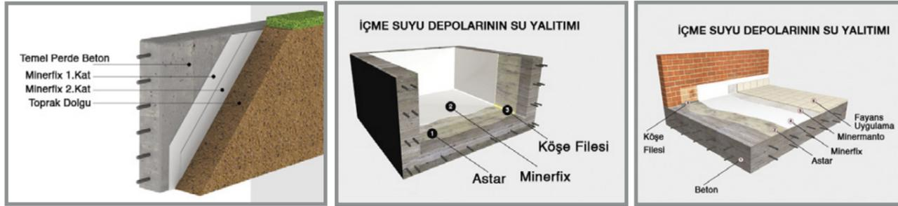
Çimento esaslı, negatif ve pozitif su basıncına dayanıklı, çimento esaslı yüzeylerin kapiler boşluklarına transfer olabilen, tek bileşenli, kristalize su yalıtım harcı.
